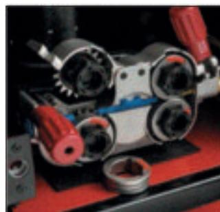
4-х роликовый (диам. 37 мм) механизм протяжки сварочной проволоки промышленного класса.
