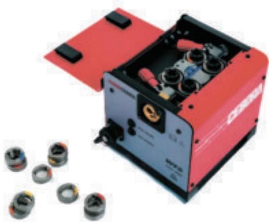
**Выверенный программный код** позволяет реализовать **подачу холодной присадки** в зону сварки в синхронизации с частотой сварки импульсной дугой.
