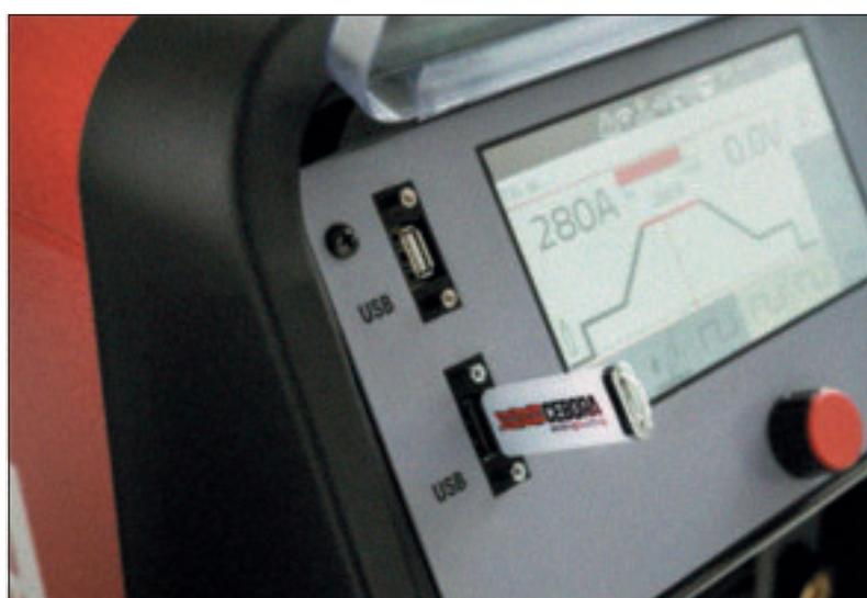
USB-устройство для обновления программного обеспечения
