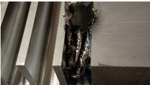
Изобр. 2: Нет вытягивания инструмента при использовании Safe-Lock™ Image 2: No pull out of the tool with Safe-Lock™
